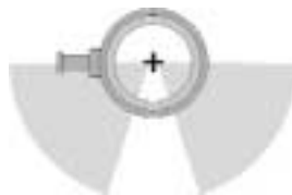
Lagebereiche für den T-förmigen Schlauchanschluss
